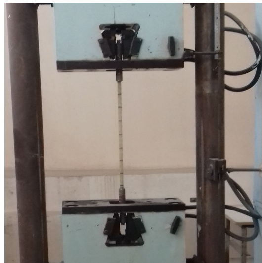
2-расм. Шиша композит арматура намунасини чўзилишга синаш жараёни
