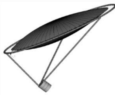
Рис. 7. Надувной рефлектор апертурой 50 м
