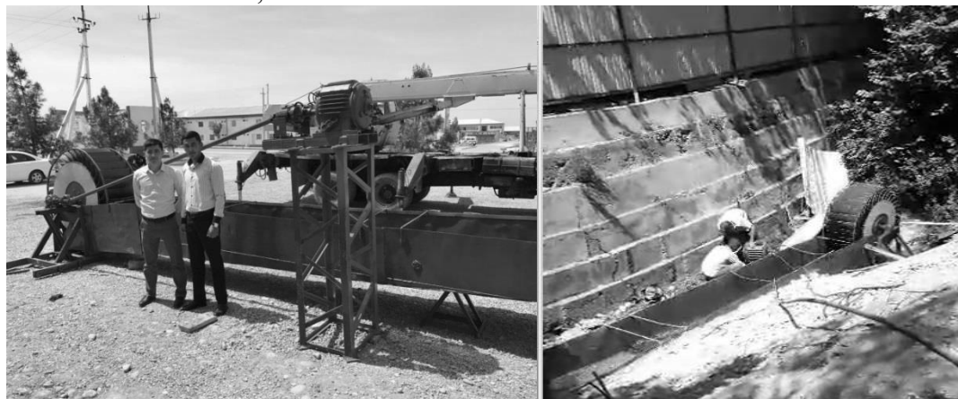
Рис.4. Общий вид микро-ГЭС с редуктором и карданной передачей от гидроагрегата к генератору на неодимовых магнитах
