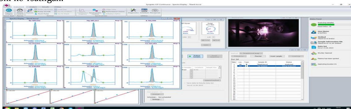
3-rasm Avio 200 ICP-OES qurilmasidagi mikroelementlarni tahlil jarayonidan.
