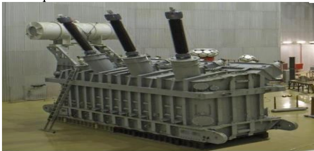
1 – rasm. TI-630000/330 tipli kuch transformatori zavodning tajriba zalida.
