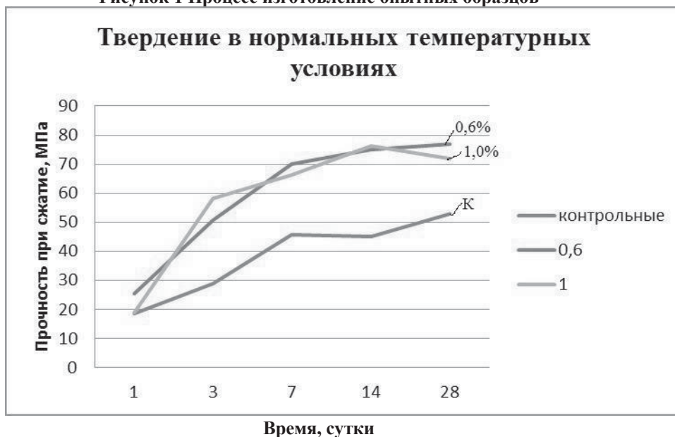
Рисунок 2 Влияние комплексной химической добавки КДж-3 на прочность при сжатии бетона
