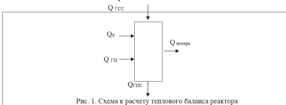
Рис. 1. Схема к расчету теплового баланса реактора
