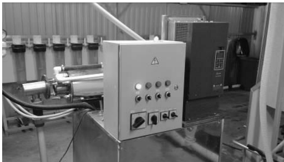
Рис. 2. Аппарат вихревого слоя с аппаратурой управления конструкции ООО «Пром-Эко», г. Белгород, партнёр БГТУ им. В.Г. Шухова
