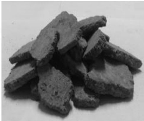
Рис.1. Форма клинкера, предварительно деформированного в ПВИ
