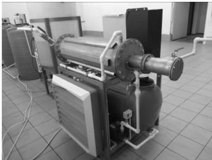
Рис. 4. Реактор роторно-вихревого типа модульной конструкции
