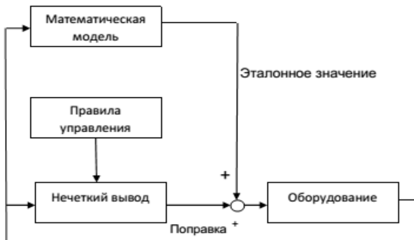
Рис. 1. Пример структурирования нечеткого вывода.
